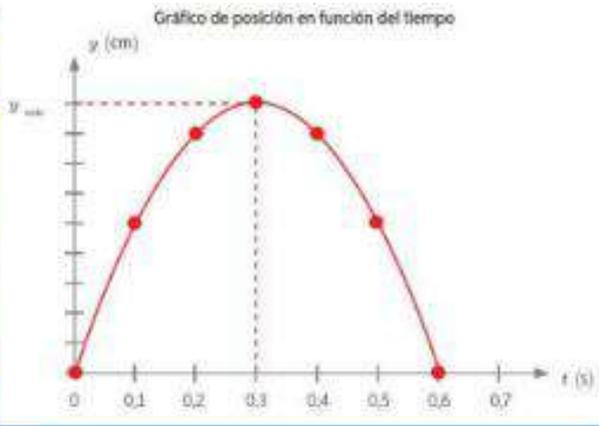
El lanzamiento vertical, ya sea hacia arriba o hacia abajo, se caracteriza por ser un movimiento rectilíneo uniformemente acelerado (MRUA), que siempre posee una velocidad inicial distinta de cero, en el cual interactúa con la aceleración de gravedad.
